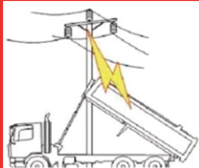
Danger inhérent aux lignes électriques aériennes à aborder lors de la formation initiale du transporteur.
